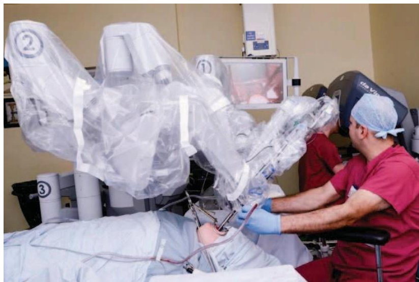
Figura 3. Robô e cirurgiões durante o procedimento. O cirurgião-chefe fica sentado em um console distante e opera em uma verdadeira visão endoscópica tridimensional do campo cirúrgico. O cirurgião assistente fica sentado em frente à cabeça do paciente, inserindo instrumentos intercambiáveis como eletrocautério, fórceps, e sucção em 2 braços de instrumentos.
