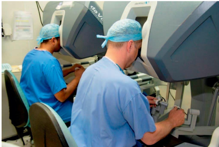
Figura 1. Consola de control donde los cirujanos manejan el sistema robótico a distancia del paciente que está en el quirófano. La consola puede usarse también para propósitos de entrenamiento.
