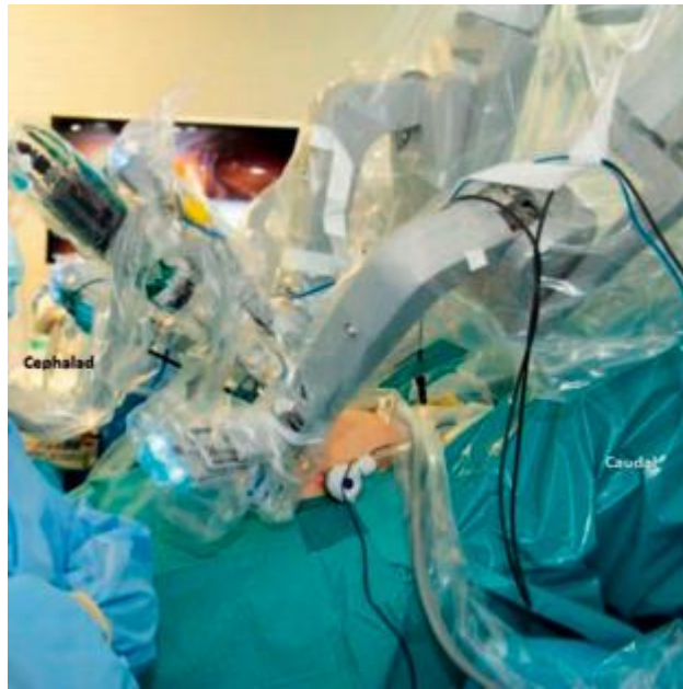
Figura 3. Robot ensamblado, mostrando el acceso limitado al paciente. El espacio dentro del quirófano también está reducido.
